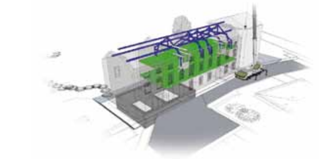
Pose des nouvelles charpentes. Renforcement des dalles planchers avec des dalles collaborantes en béton. Poursuite de la construction de l'annexe. Einbau des neuen Tragwerks; Verstärkung der Fußbodenplatten durch zusätzliche Betonplatten; Fertigstellung der Konstruktion des Anbaus.
