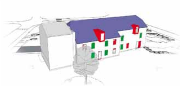
Perçement de nouvelles ouvertures (en rouge). Dégagement des ouvertures maçonnées pendant les travaux (en vert). Pose des fenêtres et portes. Durchbruch neuer Öffnungen (rot); Befreiung der während der Arbeiten zugemauerten Öffnungen (grün); Fenster- und Türeneinbau.
