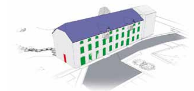
Perçement de nouvelles ouvertures (en rouge). Dégagement des ouvertures maçonnées pendant les travaux (en vert). Pose des fenêtres et portes. Durchbruch neuer Öffnungen (rot); Befreiung der während der Arbeiten zugemauerten Öffnungen (grün); Fenster- und Türeneinbau.
