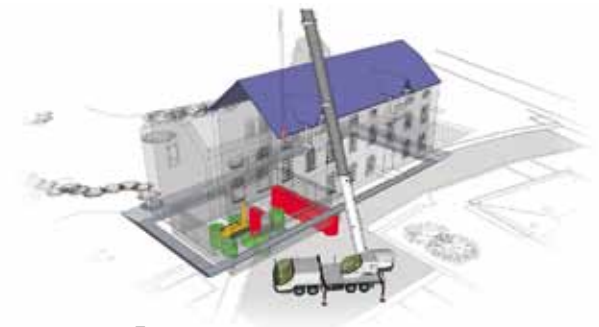
Injections « HDI » dans la partie du bâtiment démonté. „HDI“-Injektion in den abmontierten Teil des Gebäudes.
